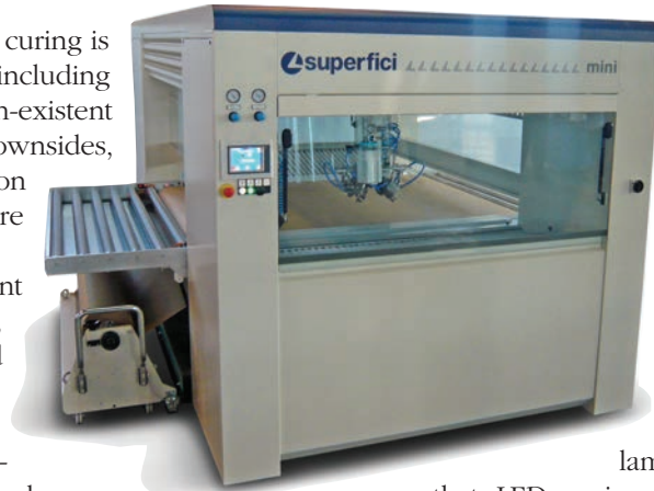
Superfici's UV Mini curing system.
